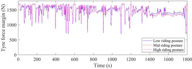
Fig. 11. Rear tyre force margin ( $\mu=1$ ).
