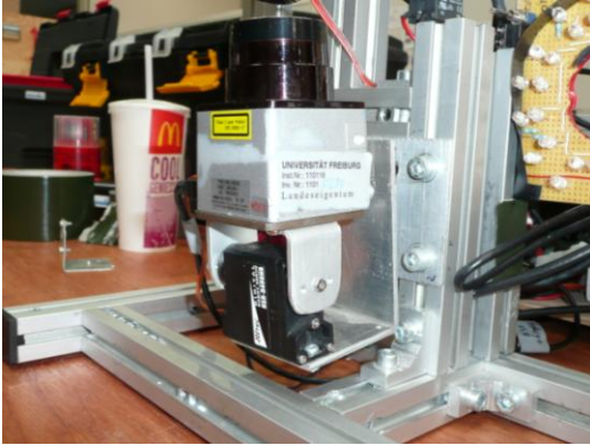
Figure 3 – A gimballed LIDAR used on Universität Koblenz-Landau’s Resko robot.
